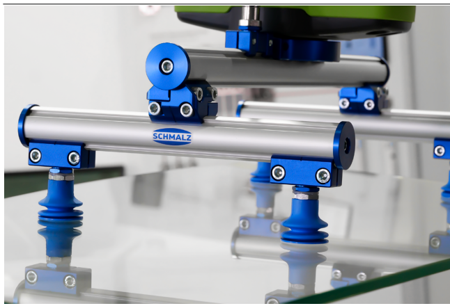
Sistema modular de garras PXT manipulando un cristal
